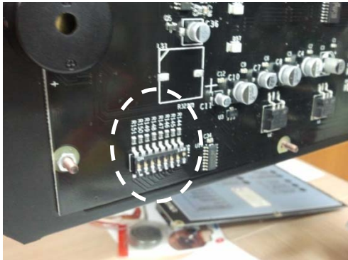
Figura 11 Ubicación del microswitch en la parte posterior del circuito CPU
