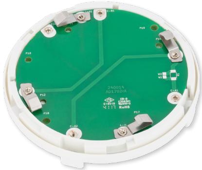
Para facilitar la tarea de actualización del sistema TC25/A a sistema Lyon (y en general, del sistema convencional), Cofem dispone de una “base de interconexión”, que permite colocar los detectores del sistema analógico y convencional directamente sobre los zócalos de sistemas superiores sin necesidad de cambiar ni cablear de nuevo los zócalos.
