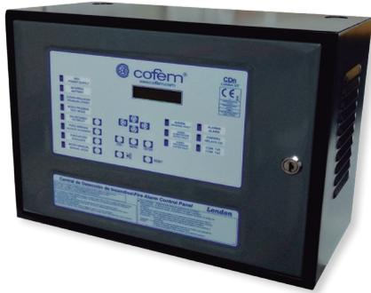
La central LONDON permite conectar hasta un máximo de 10 repetidores, mediante una conexión de 4 hilos de 1,5 mm<sup>2</sup> (dos de alimentación y dos de comunicación para la línea RS485). Los dos hilos de la línea RS485 se conectarán desde el back panel de la central al back panel de sus correspondientes repetidores.
