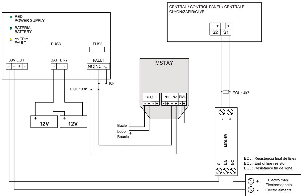
Esquema de conexionado
