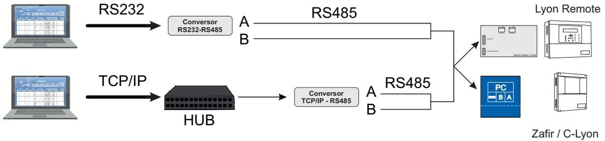
Ejemplo de conexionado en red y con I-link.
