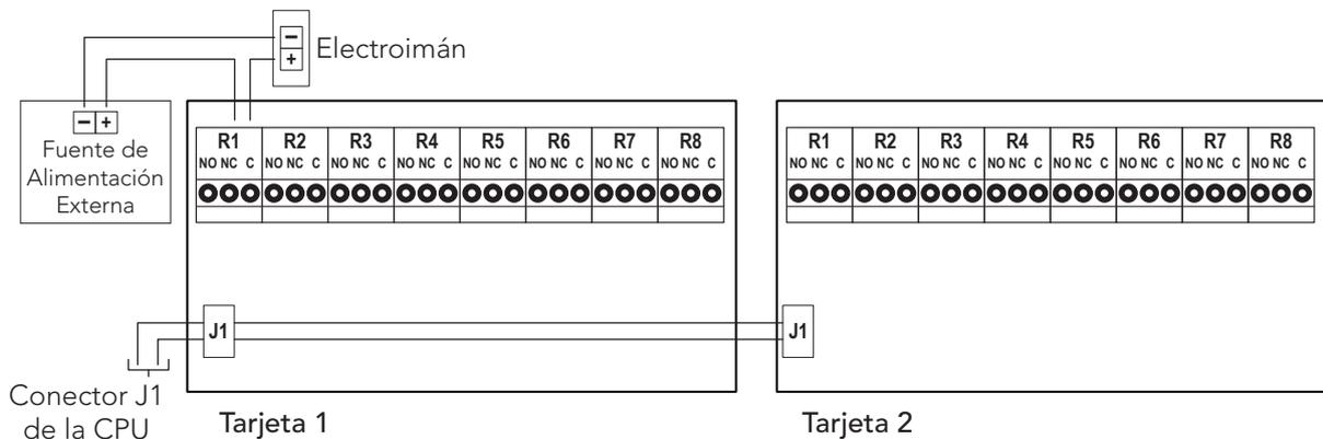
\* **NOTA 4:** Cada relé de contacto seco tiene una capacidad máxima de 0,5A 30Vdc/230Vac.
