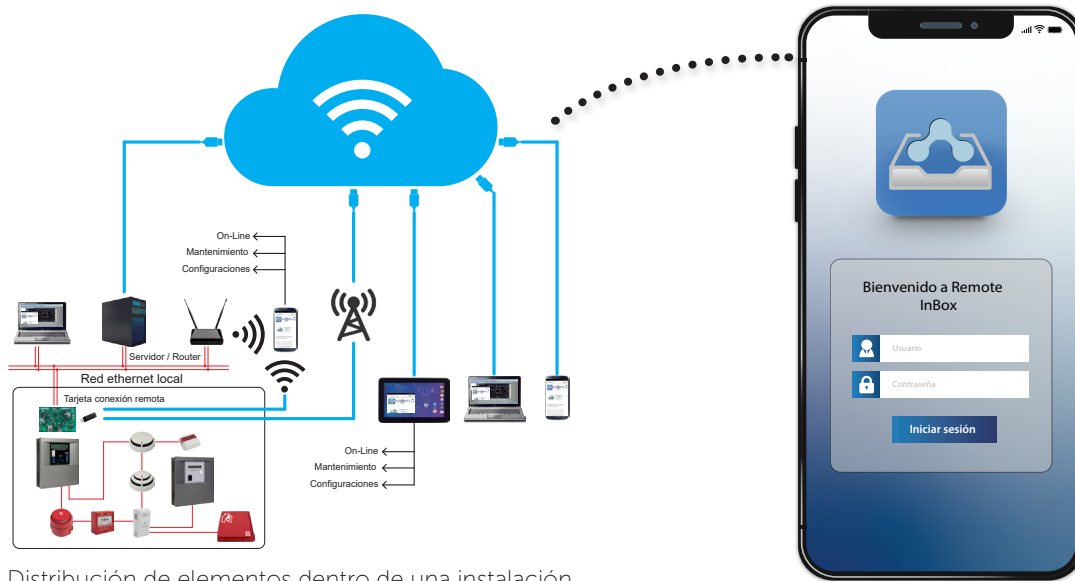
Distribución de elementos dentro de una instalación
